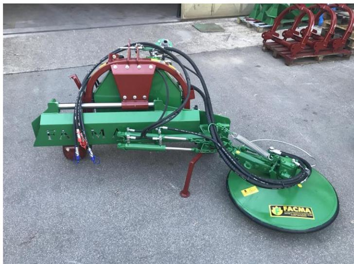
**Discul interfilărilor hidraulic independent** ce poate fi conectat direct la tractor prin intermediul prinderii în trei puncte. Este alimentat de la priza de forță și este conectat la prizele hidraulice ale tractorului. Este dotat cu rezervor, pompă, distribuitor, cuplaje hidraulice, multiplicator de turații, kit mișcare laterală. **Kit palpator hidraulic la cerere.**
