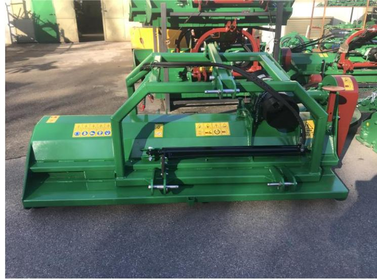
Modelul VPE poate fi fabricat, la cerere, în **versiune reversibilă, montat atât în fața cât și în spatele tractorului.**
