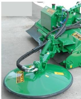
Disc interfilare hidraulic
