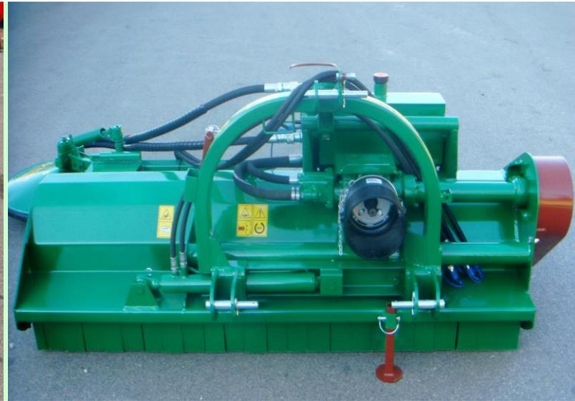
Modelul BPEL este recomandat pentru tocarea **stratului de iarbă, al corzilor viței de vie și a pietrelor mobile cu diametru de până la 6 – 7 cm**. Carcasă din tablă anti-uzură domex, oțel structural de înaltă rezistență. Prinderea este disponibilă cu acționare manuală sau hidraulică. Poate fi montat pe tractoare cu putere cuprinsă între 25 și 100 CP.
