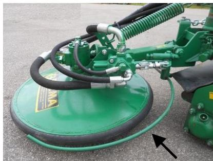
Palpator hidraulic pentru reintrarea discului, pentru:
